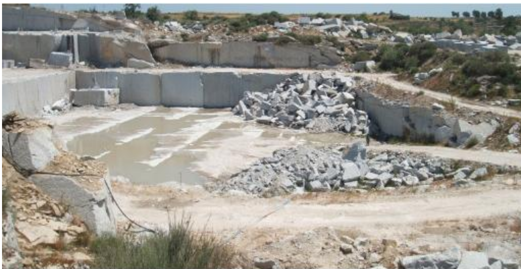
Figura 35: Bancada de extração de granitos na zona de intervenção
