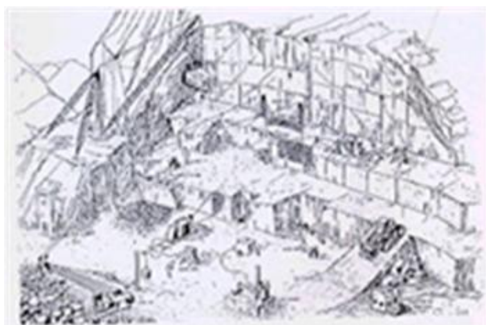
Figura 4: Exemplo do faseamento de desmonte de uma pedreira em laboração. Fonte IGM - Plano de Lavra
